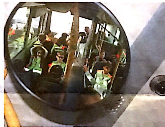
Nicht nur durch den Rückspiegel, sondern auch durch den Spiegel in der Busmitte kann der Busfahrer das Geschehen im Bus gut überblicken.
